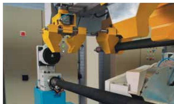
由于壁厚 1mm 的误差都可能影响到泵软管25% 的寿命，每个泵软管都经过了精工制造，以确保其能反复使用。
